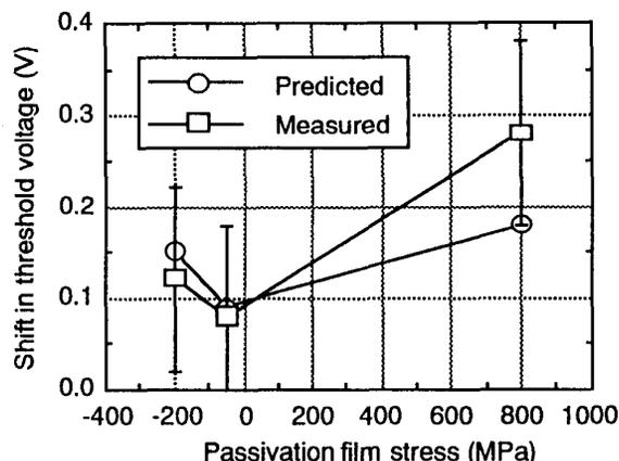
Fig. 4 Threshold voltage shift due to passivation
