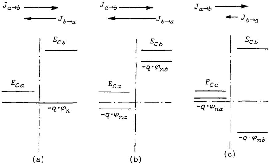
Fig. 1. Isotype heterojunction interfaces. a) Thermodynamical equilibrium. b) Forward bias. c) Reverse bias.
